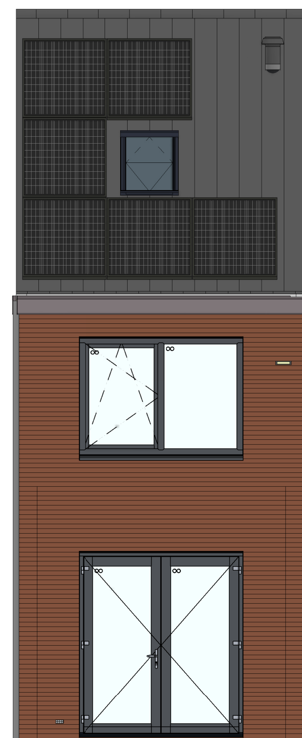
AG5008 - Achtergevel voorzien van dubbele openslaande deuren
